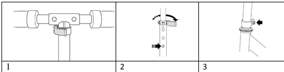
1. Platzieren Sie die Griffe in den T-förmigen Lenkstangen. Achten Sie darauf, dass die Federknöpfe durch die Löcher sichtbar sind, um diese in der richtigen Position zu sichern.
