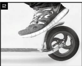
1. Achten Sie darauf, den Lenker mit beiden Händen fest zu halten und sich in einer geraden Linie zu bewegen. Schieben Sie einen Fuß zurück zum Hinterrad des Trolleys.
