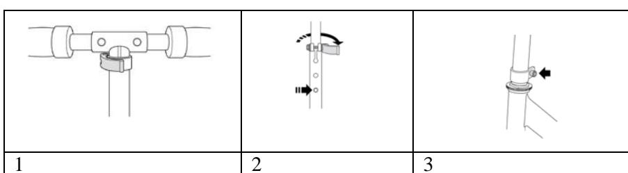
1. Introduceți mânerele în găurile kormilo. Uverete care butoanele cu arc în formă de T sunt vizibile prin găurile să fie fixate strâns în poziția corectă.
